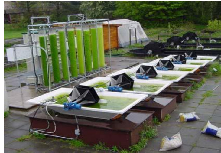
High Rate Algal Ponds in de VS (links en cascade systeem op pilot schaal van ECN, UvA en IVAM (rechts), Bron: Platform Groene Grondstoffen (2006)
