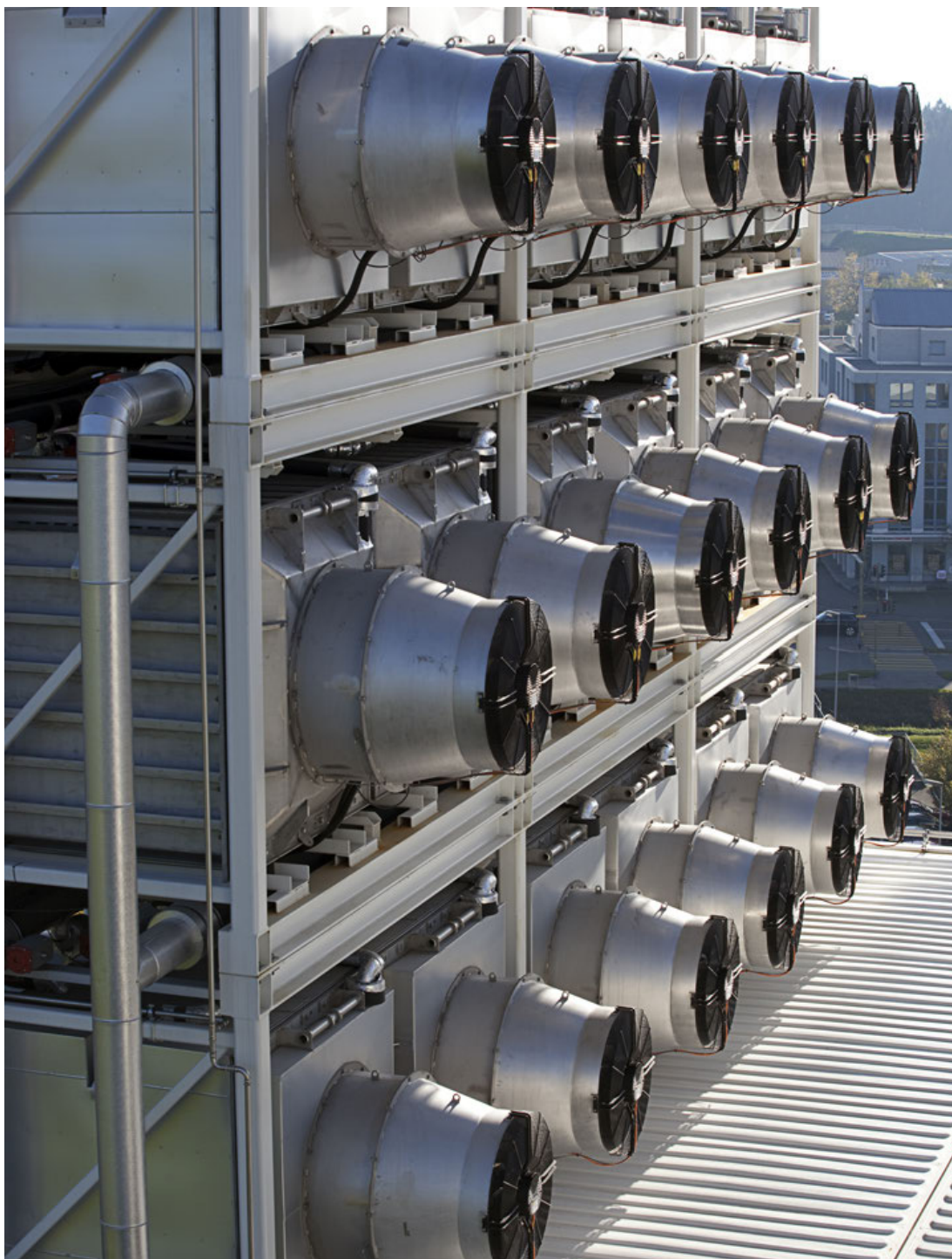
Zwitserse proefopstelling om CO 2 uit de lucht te filteren. Door CO 2 uit de lucht te halen en te hergebruiken kunnen zelfs negatieve emissies ontstaan.
